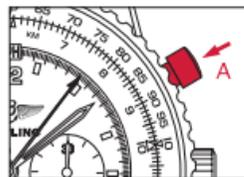
2. Zum Stoppen der Messung erneut Drücker **A** betätigen. Die Messung erfolgt in Stunden [Zähler 1], Minuten [Zähler 2], Sekunden und 1/4-Sekunden [Zeiger 3].
