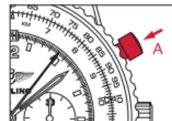
2. Parar a medição premindo novamente o pistão **A**. A medição é efetuada em horas (contador 1), minutos (contador 2), segundos e 1/4 de segundo (ponteiro 3).
