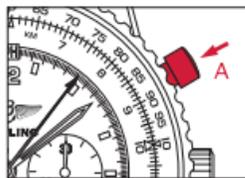
2. Interrumpir la medida presionando nuevamente el pulsador **A**. La medida se efectúa en horas [contador **1**], minutos [contador **2**], segundos y  $\frac{1}{4}$  de segundo [aguja **3**].
