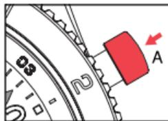
2. 再按一次按鈕A，即可結束計時。計時的結果以小時（計時盤1）、分鐘（計時盤2）、秒鐘（指針3）為單位顯示於錶面。
