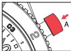
2. Для остановки хронографа еще раз нажмите кнопку **A**. Показания об измеряемом отрезке времени можно прочитать: в часах (счетчик **1**), минутах (счетчик **2**) и секундах (стрелка **3**).
