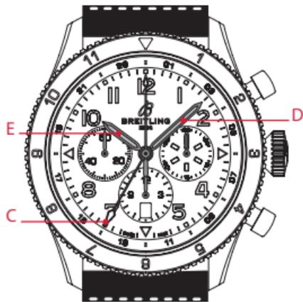
3. リューズを2の位置まで戻し、時針E (12時間表示) をいずれかの方向に回します。日付表示は、時針の前進・後退に同期して自動的に替わります。
