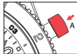
2. クロノグラフを停止させるには、もう一度ボタンAを押します。経過時間は、時 (1)、分 (2)、秒 (3) 単位で測定できます。
