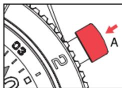
2. Arrêter la mesure en appuyant à nouveau sur le poussoir **A**. La mesure s'effectue en heures (compteur **1**), minutes (compteur **2**), en secondes (aiguille **3**).
