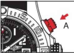
2. Для остановки хронографа еще раз нажмите кнопку **A**. Показания об измеряемом отрезке времени можно прочитать: в часах (счетчик **1**), минутах (счетчик **2**), в секундах и  $\frac{1}{4}$  доли секунды (стрелка **3**).
