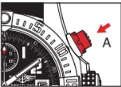
2. Fermare la misurazione premendo di nuovo il pulsante **A**. La misura si effettua in ore (totalizzatore **1**), in minuti (totalizzatore **2**), in secondi e in quarti di secondo (lancetta **3**).
