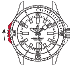
Configuração 1: bisel bloqueado
