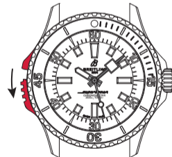
Configuração 2: bisel desbloqueado
