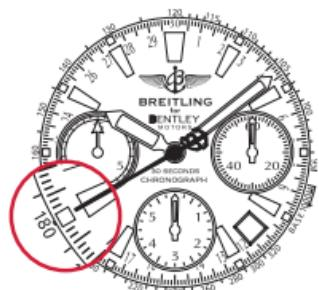
*Exemple 2:* S'il faut 36 secondes pour parcourir un kilomètre ou un mile, la vitesse moyenne est de 100 km/h, respectivement 100 mph.
