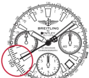
*Ejemplo 2:* si se invierten 36 segundos en recorrer un kilómetro o una milla, la velocidad media será de 100 km/h, o de 100 mph respectivamente.
