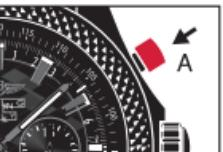
2. 再按一次按鈕A，即可結束計時。計時的結果以小時（計時盤1）、分鐘（計時盤2）、秒鐘與 $\frac{1}{8}$ 秒（指針3）為單位顯示於錶面。
