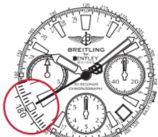
*Exemplo 2:* Se forem necessários 36 segundos para percorrer um quilómetro ou uma milha, a velocidade média é de 100 km/h ou 100 mph, respectivamente.
