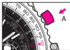
2. 時間計測を中断させるには、ボタンAをもう一度押します。時間計測を再開するには、再びボタンAを押します。このような操作で中断しながら、経過時間を測定することができます (積算計測)。
