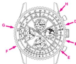
4. **Estación:** Presionar el corrector H a fin de colocar la aguja de las estaciones en la señal que precede a la estación actual. Seguidamente, ajustar la aguja de la forma siguiente:
